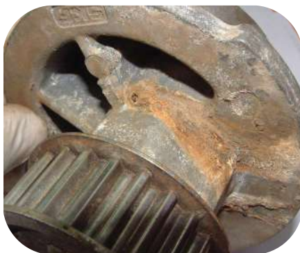
Διαρροή από την οπή αποστράγγισης με εκτεταμένα ίχνη σκουριάς
